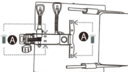
**5. Наденьте сиденье отверстием регулировочного механизма на газлифт**
